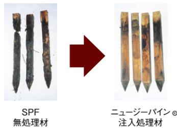
ニュージーパイン<sup>®</sup>を防腐防蟻処理したウッドデッキ製品。野外杭試験で従来のSPF(スプルース・パイン・ファーの総称)材よりも高い耐久性が確認されました。
