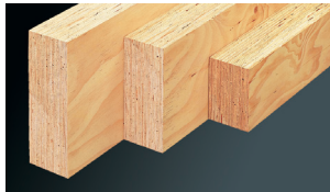
■ LVL (Laminated Veneer Lumber) 単板の繊維方向を平行に揃え接着した単板積層材
