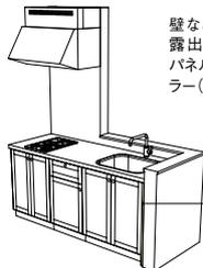
壁などによってシンク横が露出しない場合は、サイドパネルの代わりにベースフィラー(差込用)を使用します。
