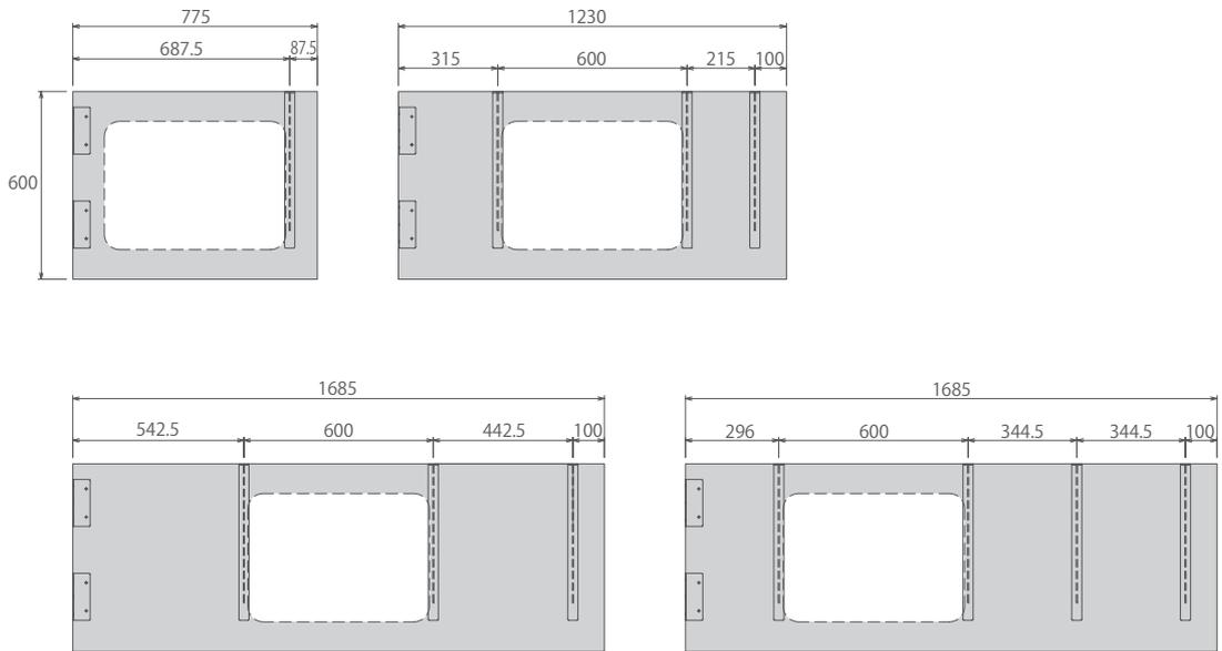
□特注サイズ例 ブラケット納まり参考図(左側壁納まり・右側オープン)
