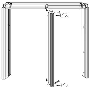
枠材の本固定後、モヘアが取り付けいた方を枠側に向け、中方立を同梱の組み立て用ビスで確実に固定してください。水準器などを使用して垂直に中方立を取り付けるようにしてください。
