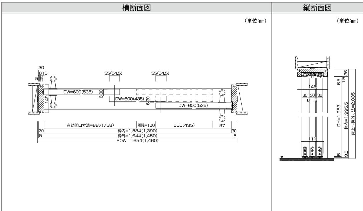
**固定枠** 固定枠には躯体接合金具が付いていないので、枠外寸法に合った開口を設けてください。
