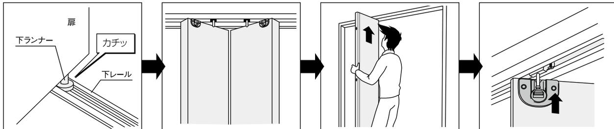
※下ランナーを下レールの溝に落とし込む
