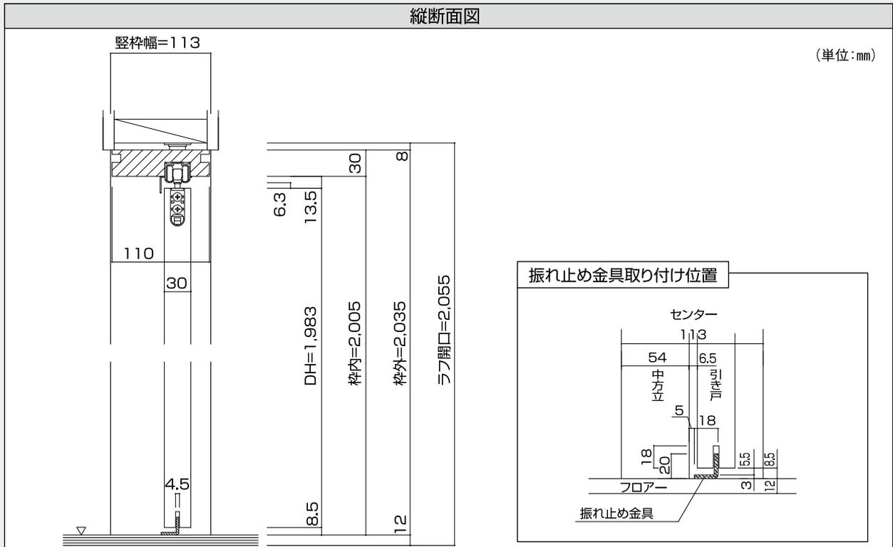
【幅広片引き戸(固定枠155mm幅)】 納まり図
