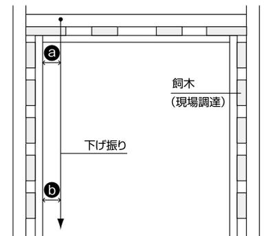
水準器などを使用し、㊦=㊧となるよう調整してください。併せて前後の建りも調整してください。
