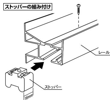
扉を開いた時に、床付けガイドから扉から露出しない(外れない)位置に、同梱のストッパーをレールに組み付けてください。尚、ストッパー組み付けの際は予めレールにφ3mmの穴をあけてストッパーをビス固定してください。
