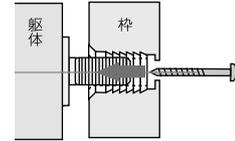
枠材表面の穴よりビスを差し込み、柱と枠を固定します。
