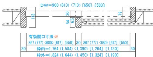
※パー引き手、もしくは大型サムターン表示錠使用時は、引戸引き残しストッパーをご使用ください。ただし、有効開口は102ミリ狭くなります。
