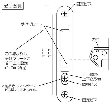
1. 受けプレートの調整ビスを受けプレートが動く程度にゆるめます。
