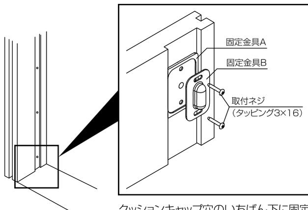
クッションキャップ穴のいちばん下に固定金具Aを差し込み、固定金具Bをかぶせ、位置決めを行い、ビス止めします。
