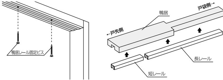
長レールを戸袋側の壁柱に寄せてレールを取り付けてください。
