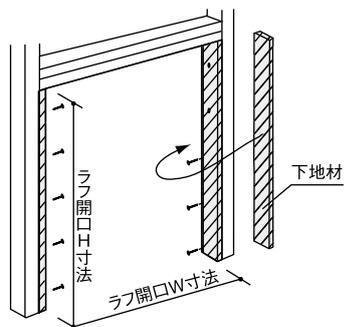
開口部に下地材を取り付け、納まり図参照の上、枠外寸法に見合ったラフ開口を設けてください。
