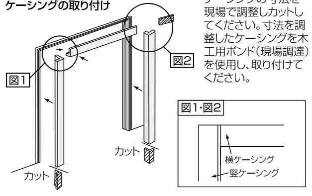
ケーシングの寸法を現場で調整しカットしてください。寸法を調整したケーシングを木工用ボンド(現場調達)を使用し、取り付けてください。
