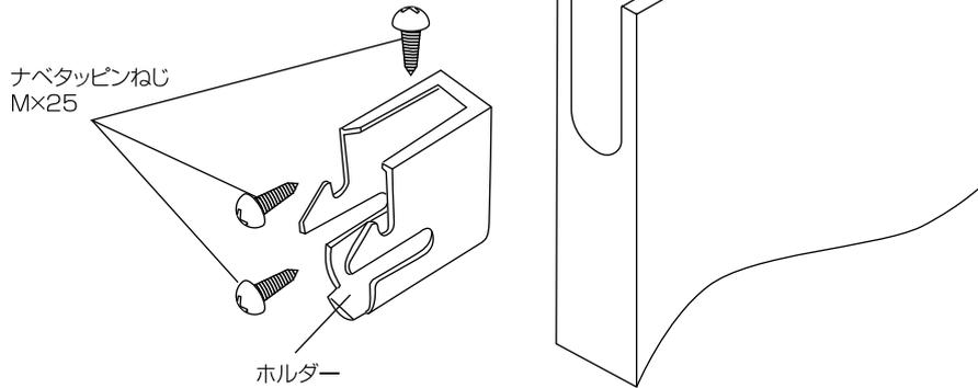
床に取り付けた振れ止め金具に引き戸をひっかけ、戸尻側の吊車をスライドさせ、固定カップにカチッと音がするまで差し込んで取り付けてください。戸尻側の吊車を取り付けたら、ゆっくり扉をレールと平行になるようにスライドさせていきます。扉がレールと平行になったら、戸先側の吊車を先程と同様に固定カップにカチッと音がするまで差し込んで取り付けてください。
