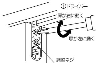
引き戸をご使用の際に、引き戸と中方立の間の隙間が大きい、または、逆に隙間が少なくて引き戸同士、または引き戸と中方立が擦れるような場合には、上部ガイドと戸車の左右調整を行ってください。(上側の調整ネジ)
