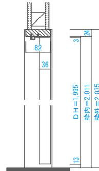
■縦断面図[4方枠 (床直付けレール)]
