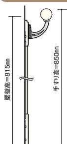
パネル上部の横見切りには丸形手すりのブラケットが取り付け可能。より安全な住まいづくりのために、手すりの設置をご提案します。
