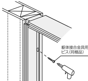
堅枠を躯体接合金具用ビスで躯体に固定させます。
