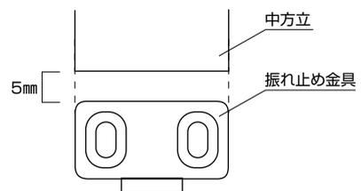
振れ止め金具(床付け用)を下図のように床に取り付けます。
