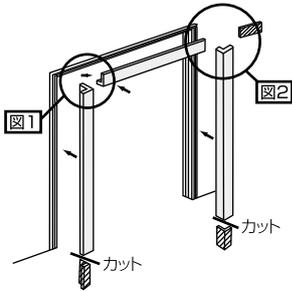
ケーシングの寸法を現場で調整しカットしてください。寸法を調整したケーシングを木工用ボンド(現場調達)を使用し、取り付けてください。
