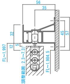
レール下端が床面から1,985mmに取り付けて下さい。
