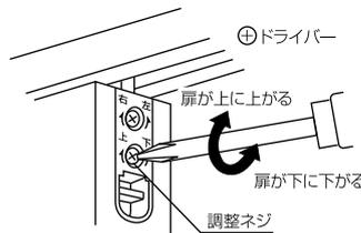
隙間の状態を確認後、プラスドライバーにて吊車の上下調整ネジで調整を行い、縦枠と引き戸の隙間をなくしてください。その際は、両側の吊車2つとも必ず調整をしてください。(下側の調整ネジ)
