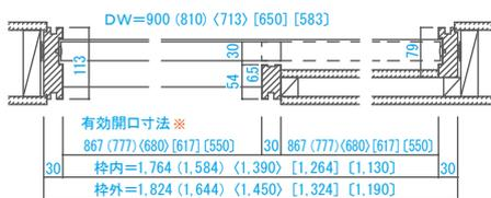
※パー引き手、もしくは大型サムターン表示錠使用時は、引戸引き残しストッパーをご使用ください。ただし、有効開口は102ミリ狭くなります。
