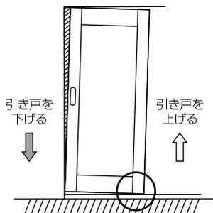
(2)引き戸と縦枠の下部に隙間が生じたとき
