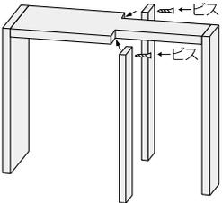
枠材の本固定後、モヘアを取り付けた方を枠側に向け、両側の中方立を同梱の組み立て用ビスで確実に固定してください。
