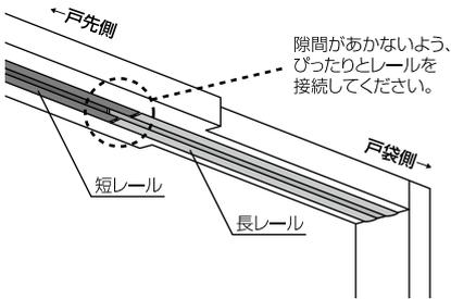
戸車挿入後、短レールを取り付けてください。
