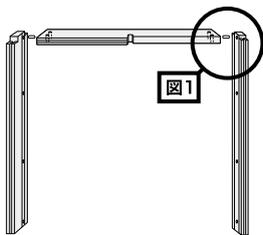
同梱の木ダボ、組み立て用ビス、木工用ボンド(現場調達)を使用して枠材を組み立ててください。
