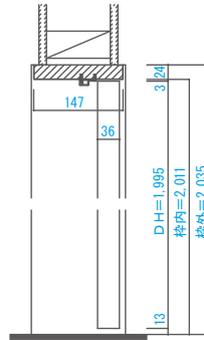
■縦断面図[4方枠 (床直付けレール)]
