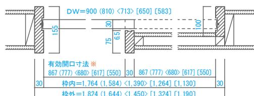
※パー引き手、もしくは大型サムターン表示錠使用時は、引戸引き残しストッパーをご使用ください。ただし、有効開口は102ミリ狭くなります。
