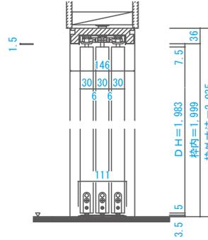
床直付けレール断面図
