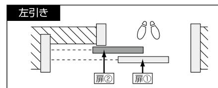
(2) 扉②に取り付けた⓪振れ止め金具に扉①をはめこみ、戸先側・戸尻側の吊車をスライドさせ、固定カップにカチッと音がするまで差し込んで取り付けください。
