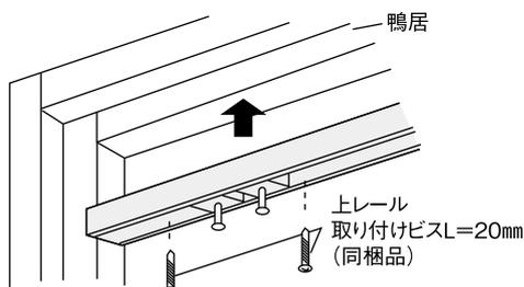
上レール取り付けの際、鴨居に直径2mmのキリで深さ10mm程度の下穴をあけ、付属のビスを使用して取り付けます。
