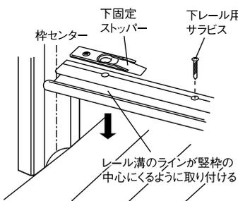
レール溝の中心にあるラインが枠材の中心にくるように取り付けてください。
