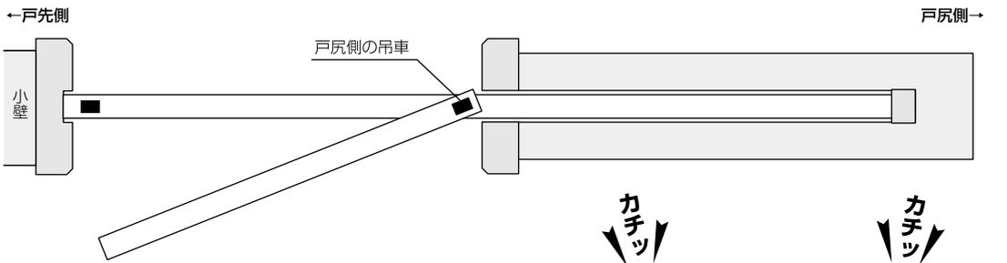
戸尻側の吊車を取り付けたら、ゆっくり扉をレールと平行になるようにスライドさせていきます。扉がレールと平行になったら、戸先側の吊車を先程と同様に固定カップにカチッと音がするまで差し込んで取り付けてください。
