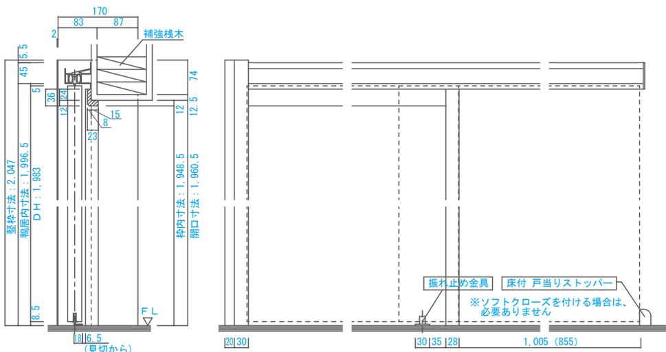
上吊り2枚連動シンクロ引き戸（上吊りタイプ）
