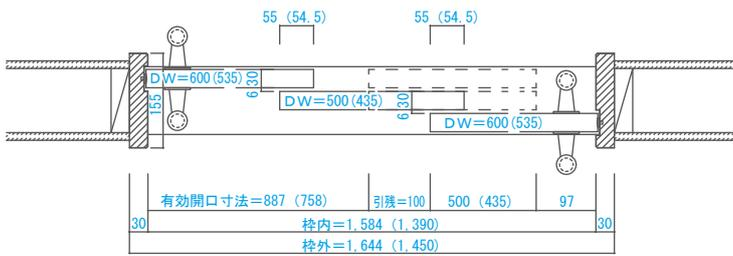
■縦断面図 [床直付けレールタイプ]
