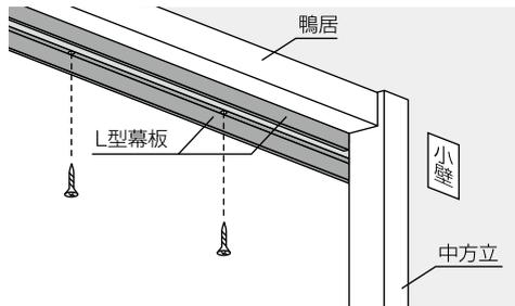
引き戸を吊り込んだ後にL型幕板上レールに合わせて両側に取り付けてください。
