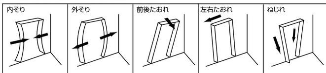
水準器などを使用し、②=①となるよう調整してください。併せて前後の建りも調整してください。
