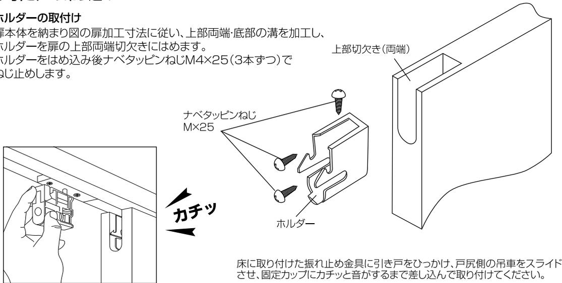
床に取り付けた振れ止め金具に引き戸をひっかけ、戸尻側の吊車をスライドさせ、固定カップにカチッと音がするまで差し込んで取り付けてください。
