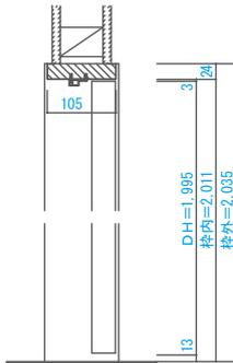
■縦断面図[4方枠 (床直付けレール)]
