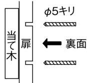
扉裏の取っ手取り付け用の加工穴(半貫通)に、穴かくしキャップを取り付ける。
