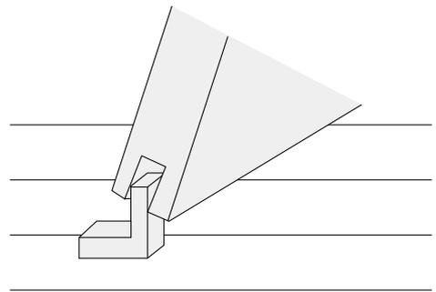
(3) 戸先側・戸尻側の吊車をスライドさせ、固定カップにカチッと音がするまで差し込んで取り付けてください。
