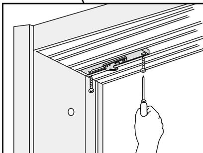
同梱のビスにて取り付けビスの締めすぎを防ぐため手回しドライバーにて取り付けて下さい。
