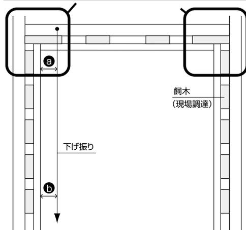
水準器などを使用し、●=●となるよう調整してください。併せて前後の建りも調整してください。
