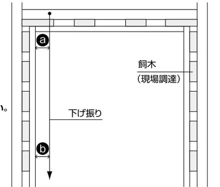
水準器などを使用し、a=bとなるよう調整してください。併せて前後の建りも調整してください。
