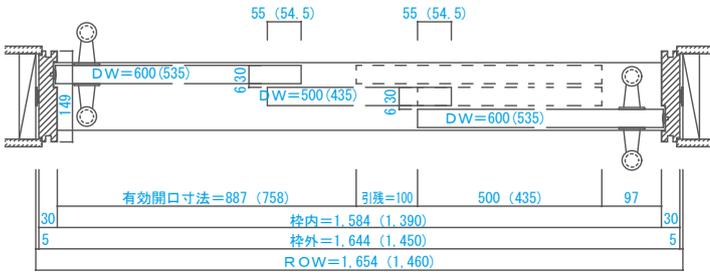
■縦断面図 [床直付けレールタイプ]
