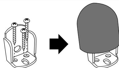
ソフトクローズ機構が作動しない側の引き戸下に床付けストッパーを取り付けます。取り付ける場所、取り付けが必要な仕様については、納まり図をご確認ください。
