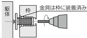
同梱のミニレンチをインパクトドライバーにチャックして、時計回りに廻し、金具の足を柱まで伸ばします。チャックできないインパクトドライバーの場合は、ミニレンチの十字にビットを差し込んでご使用ください。
