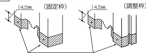
縦枠の下端をカットした後、欠き込みに合わせてレール下地ベースを取り付け、裏からビスで固定します。
