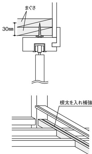
枠材は、捨て張り合板の上に施工するか、根太の上に直接施工する場合は、必ず図のように根太を入れ補強してください。
