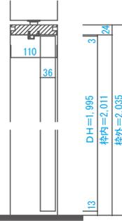
■縦断面図[4方枠 (床直付けレール)]
