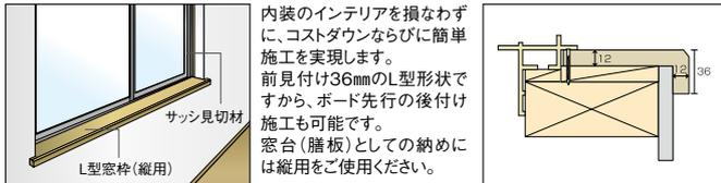
内装のインテリアを損なわずに、コストダウンならびに簡単施工を実現します。前見付け36mmのL型形状ですから、ボード先行の後付け施工も可能です。窓台(膳板)としての納めには縦用をご使用ください。
