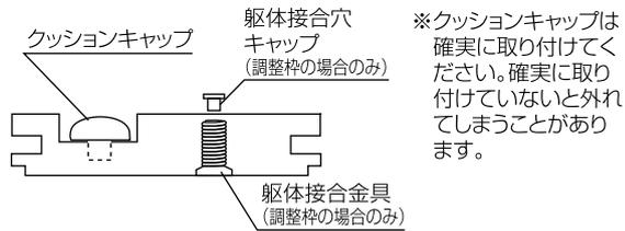
縦枠にクッションキャップを取り付けてください。
