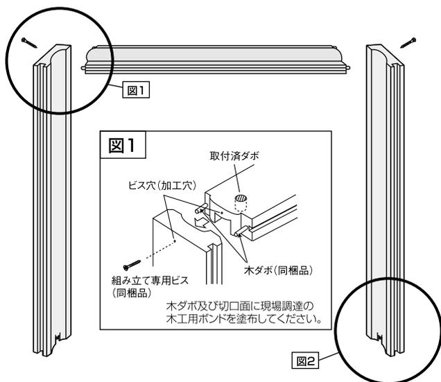
〔3方枠+床直付けレール〕 〔3方枠(レール無し)〕
