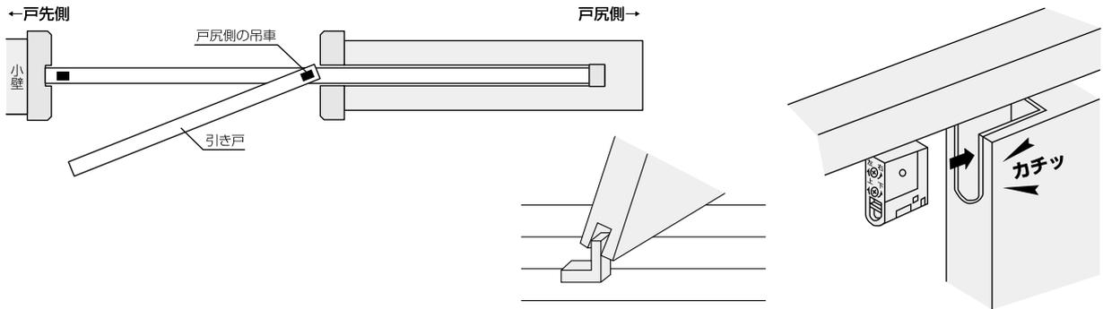
(2) 戸尻側の吊車を取り付けたら、ゆっくり扉をレールと平行になるようにスライドさせていきます。扉がレールと平行になったら、戸先側の吊車を先程と同様に固定カップにカチッと音がするまで差し込んで取り付けてください。
