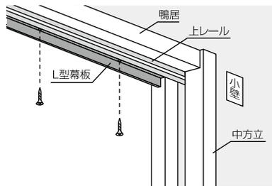
引き戸を吊り込んだ後にL型幕板上レールに合わせて取り付けてください。L型幕板は廊下側の面に取り付けてください。
