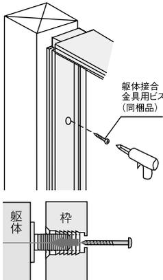
枠材表面の穴よりビスを差し込み、柱と枠を固定します。
