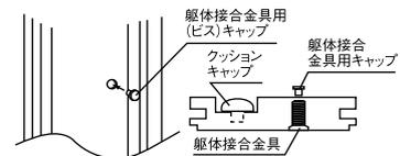
※躯体接合金具用キャップは調整枠の場合のみ取り付けます。
