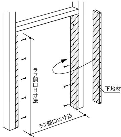
開口部に下地材を取り付け、納まり図参照の上、枠外寸法に見合ったラフ開口を設けてください。
