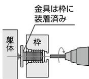
同梱のミニレンチをインパクトドライバーにチャックして、時計回りに廻し、金具の足を柱まで伸ばします。チャックできないインパクトドライバーの場合は、ミニレンチの十字にビットを差し込んでご使用ください。
