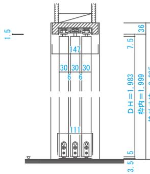
床直付けレール断面図
