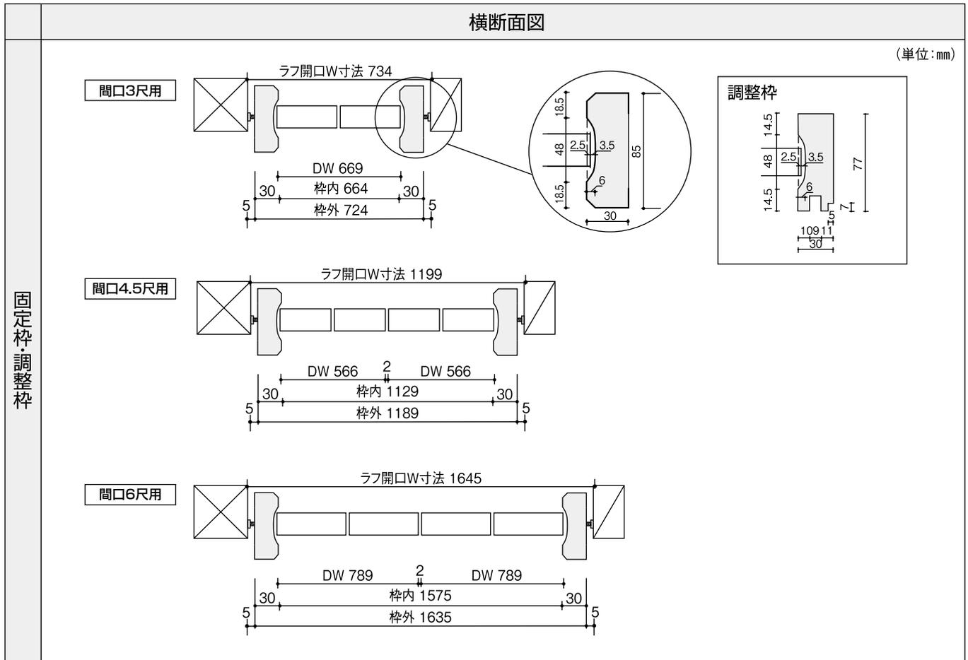
※上記納まり図は固定枠仕様ですが、調整枠の場合も同じ寸法になります。
