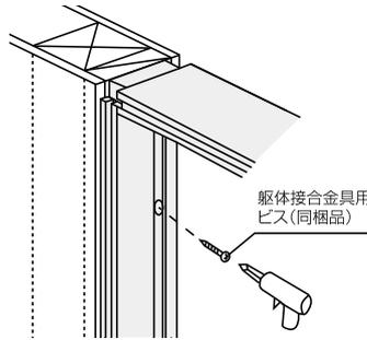
堅枠を躯体接合金具用ビスで躯体に固定させます。
