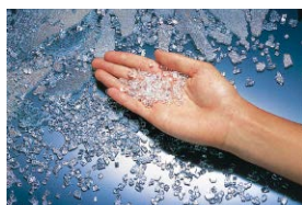
熱処理ガラスの割れた場合
