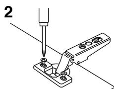
2 手締めドライバーでビスを締め込みます。
