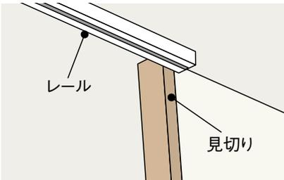
小壁を作らず、開口部には見切りのみを取り付けます。レールは壁の外に納まります。
