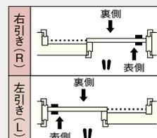
\*調整枠は躯体接合金具をフル装備していますので、枠外寸法+10mmを目安として開口を設定してください。
