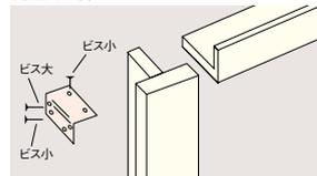
専用ビス(大)で、縦用と横用の枠を固定します。
