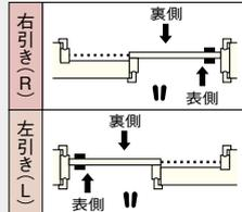
※調整枠は躯体接合金具をフル装備していますので、枠外寸法+10mmを目安として開口を設定してください。
