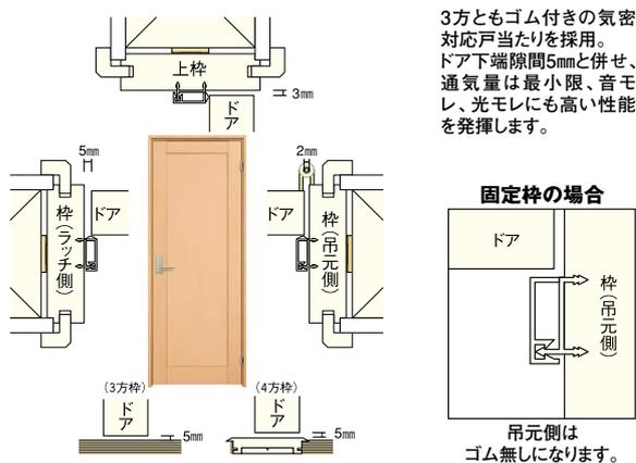
ドア専用枠材（通気不要時専用枠材）
