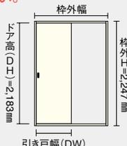
※調整枠は躯体接合金具をフル装備していますので、枠外寸法+10mmを目安として開口を設定してください。
