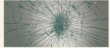
万一割れても破片が飛び散りにくい「合わせガラス」
