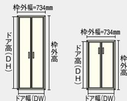
※躯体接合金具をフル装備しているものは、枠外寸法+8mmを目安として開口を設定してください。
