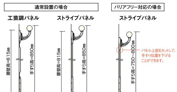
パネル上部の横見切りには丸型手すりのブラケットが取り付け可能。より安全な住まいづくりのために、手すりの設置をご提案します。
