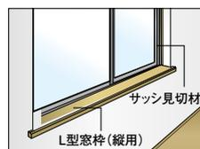
内装のインテリアを損なわずに、コストダウンならびに簡単施工を実現します。前見付け36mmのL型形状ですから、ボード先行の後付け施工も可能です。窓台(膳板)としての納めには縦用をご使用ください。
