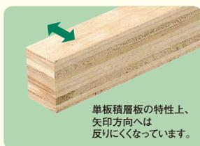
乾燥させた単板を揃えて、圧縮・接着した単板積層板を使用しているため矢印方向へ反りにくくなっています。
