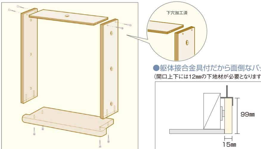
●躯体接合金具付だから面倒なパッキン調整施工が簡単。
