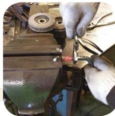
火で中央の部分を熱してねじります。手でねじることでエッジが際立ち、美しいラインが出ます。
