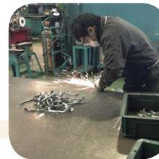
ハンマーで叩いた部分の両端をカットし、削って形を整えていきます。
