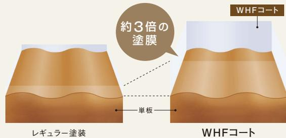
鉛筆硬度試験(JIS K5600)に準じて行った社内試験により、**3H**程度の硬度に耐える性能を確認しました。暮らしの中でつきやすいすり傷やひっかき傷など、さまざまな傷を軽減します。
