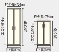
※躯体接合金具をフル装備しているものは、枠外寸法+8mmを目安として開口を設定してください。
