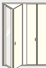
ミラー付きタイプは、一例：間口9尺の場合折れ戸の左側の扉にミラーが入ります。折れ戸の取付位置によってミラーの場所を変える事が出来ます。
