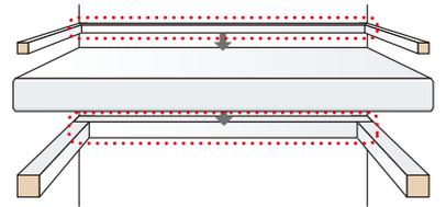
間口6尺タイプの場合、壁内寸が1,690mmに対し、製品W寸法が1,685mm。クリアランスは隙間キャップで隠せます。
