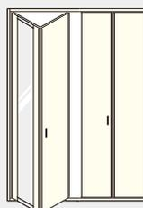
ミラー付きタイプは、一例：間口9尺の場合、折れ戸の左側の扉にミラーが入ります。折れ戸の取付位置によってミラーの場所を変える事が出来ます。
