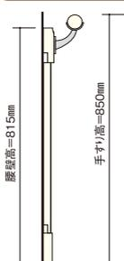
パネル上部の横見切りには丸型手すりのブラケットが取り付け可能。より安全な住まいづくりのために、手すりの設置をご提案します。
