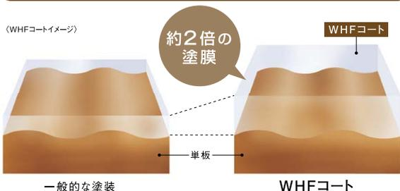
鉛筆硬度試験 (JIS K5600) に準じて行った社内試験により、**3H**程度の硬度に耐える性能を確認しました。暮らしの中でつきやすいスリ傷やひっかき傷など、さまざまな傷を軽減します。
