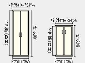
※躯体接合金具をフル装着しているものは、枠外寸法 +10mmを目安として開口を設定してください。
