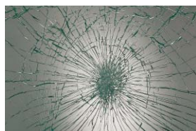
合わせガラスの割れた場合
