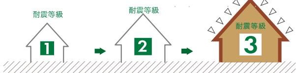
建築基準法レベル。建築基準法ぎりぎりの構造設計では阪神淡路大震災で倒壊する危険性があります。
