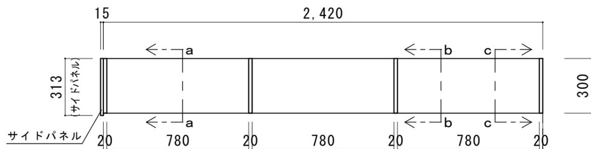
【フロート用側板：D=300】 【フロート用仕切り板：D=300】
