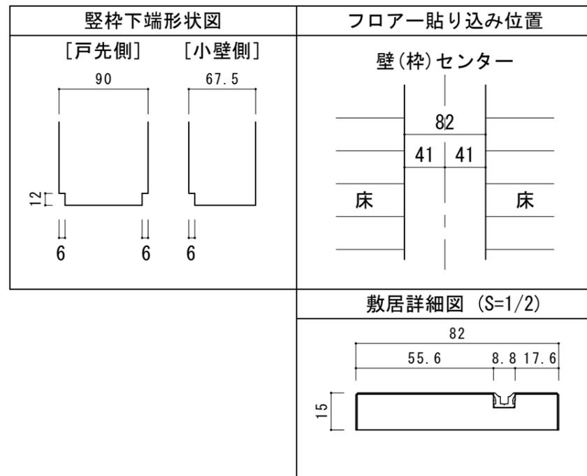
■縦断面図[床直付けレール]
