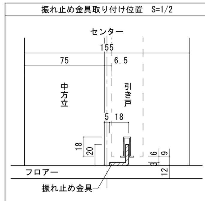
振れ止め金具(床付け用)取り付け
