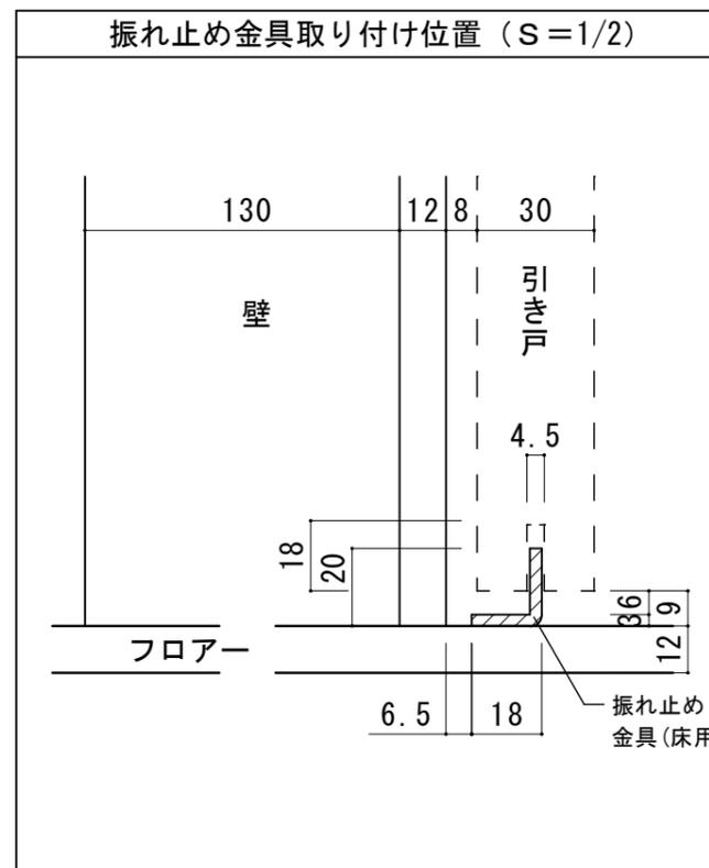
振れ止め金具 (床付け用) 取付
