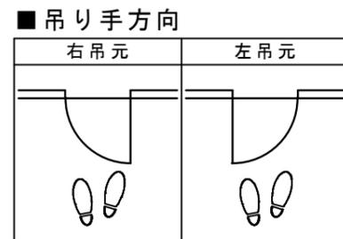
■ ドア横断面図 ※図示：右吊り元
