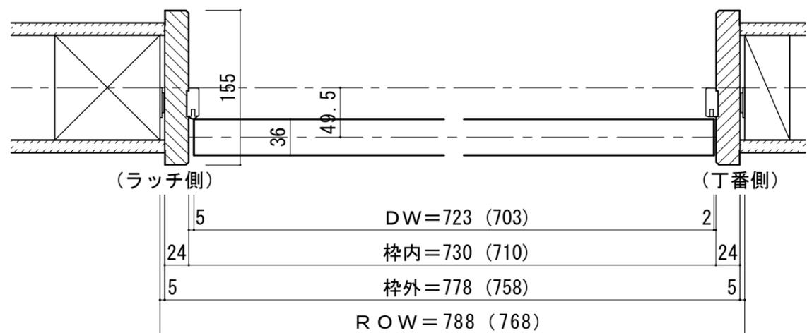
■ 欄間横断面図 ※図示：右吊り元
