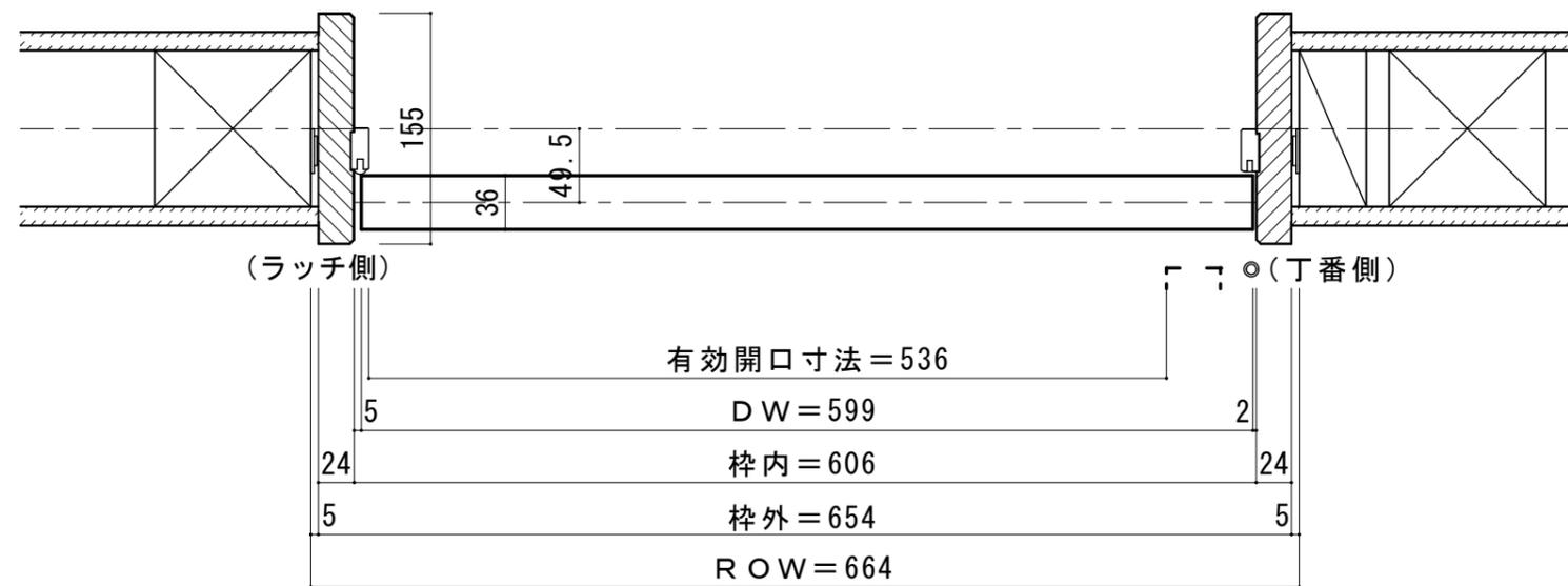
■ 縦断面図 [下枠Q型]
