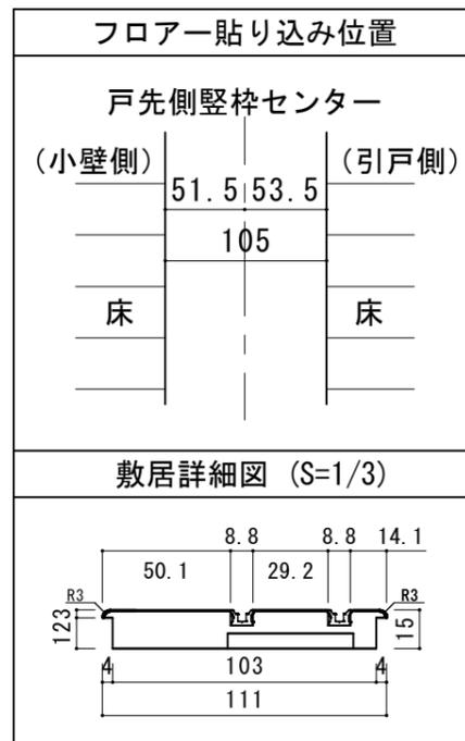
■縦断面図[床直付けレール]
