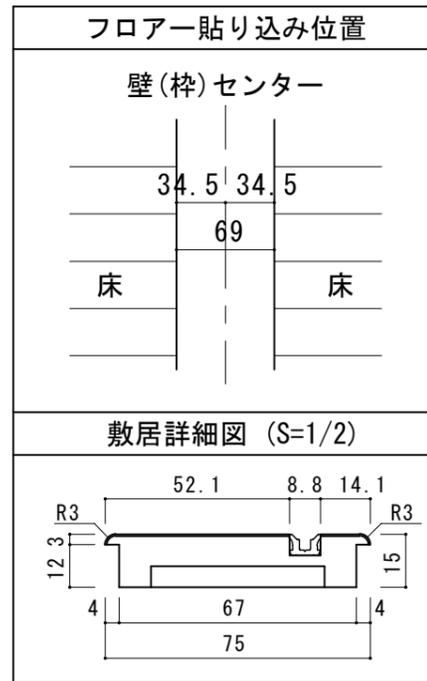
■縦断面図[床直付けレール]
