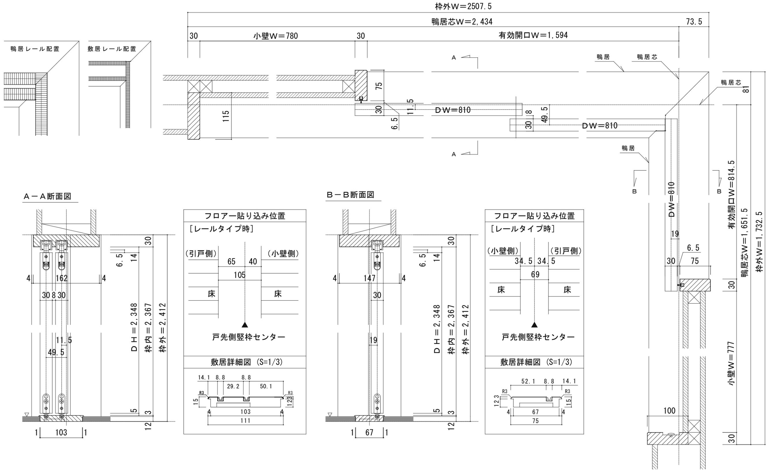
ドレタス H24 L字開口納まり枠セット レールタイプ 固定枠 敷居Q型
