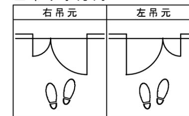
■ 横断面図 ※図示：右吊り元
