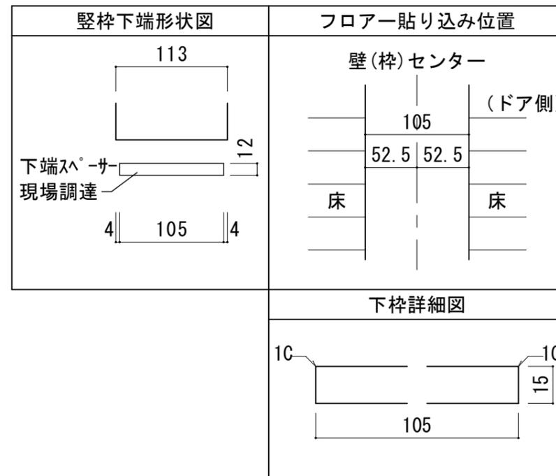
■ 縦断面図 [床直付けレール]
