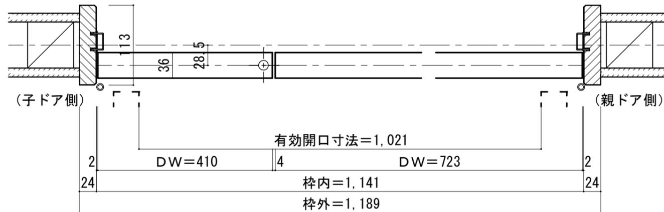
■ 縦断面図 [下枠N型]
