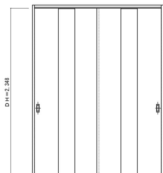
DH=2,348<br>DW=900<br>枠外幅 1,824mm (DW=900mm)<br>スリットパネル    | H 24 3方枠<br>
