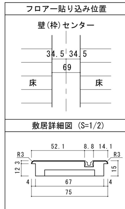
■縦断面図 [床直付けレール]
