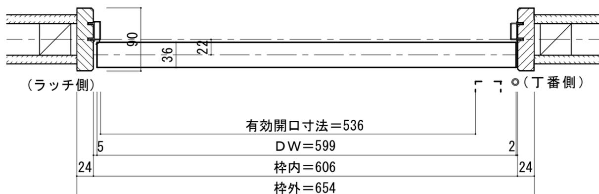
■ 縦断面図 [下枠N型]
