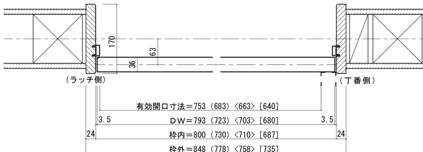
■ 縦断面図 [下枠Q型]
