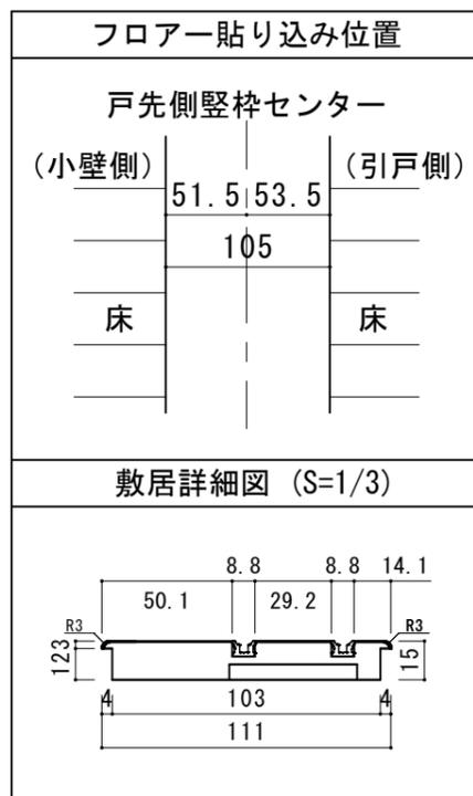
■縦断面図[床直付けレール]
