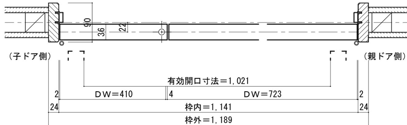
■ 縦断面図 [下枠N型]
