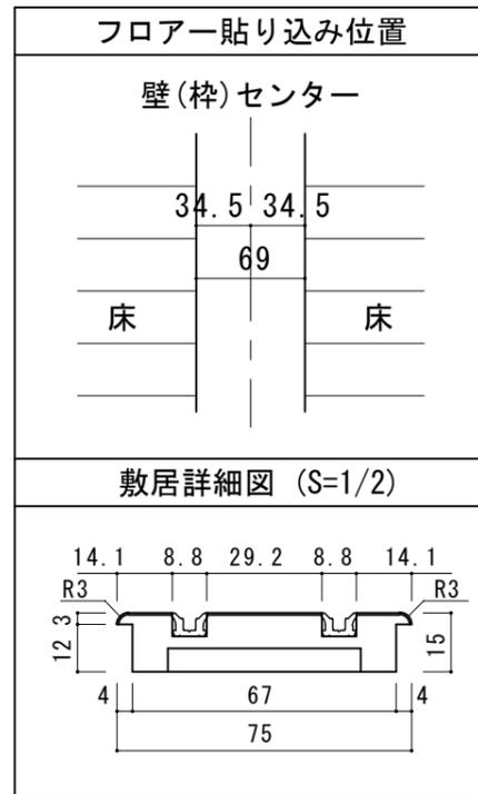
■縦断面図 [床直付けレール]
