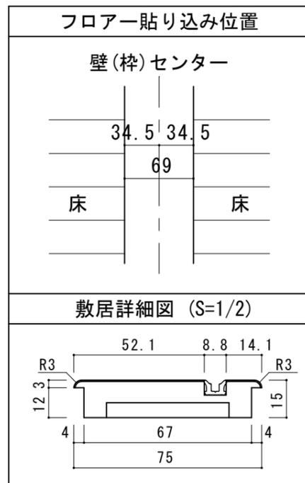
■縦断面図[床直付けレール]
