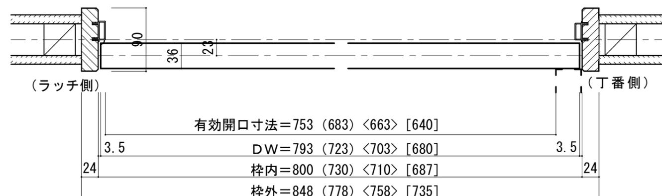
■ 縦断面図 [下枠N型]
