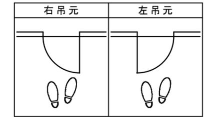
■ 横断面図 ※図示：右吊り元
