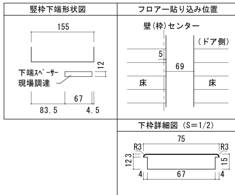
■ 縦断面図 [床直付けレール]
