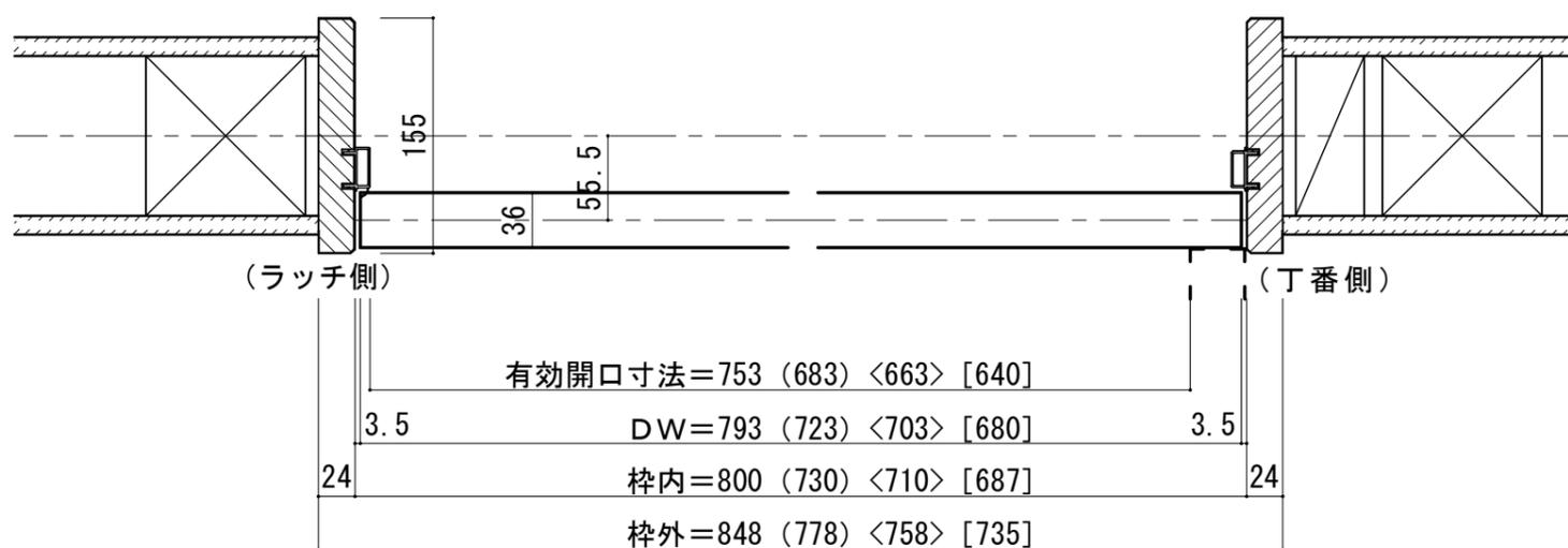
■ 縦断面図 [下枠Q型]
