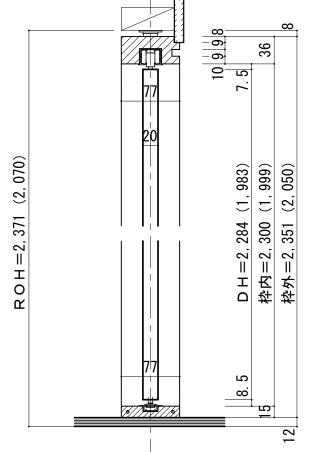
ドレタス H20クローゼットドア 調整枠 3方枠+直置敷居 間口9尺
