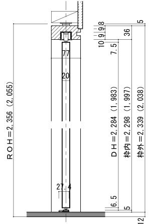
ドレタス H20クローゼットドア 調整枠 3方枠+床直付レール 間口4.5尺
