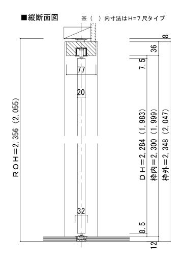
ドレタス H20クローゼットドア 固定枠 3方枠+埋め込みレール 間口9尺
