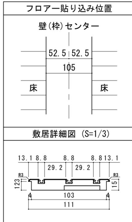
■縦断面図[床直付けレール]
