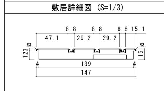
■縦断面図 [床直付けレール]
