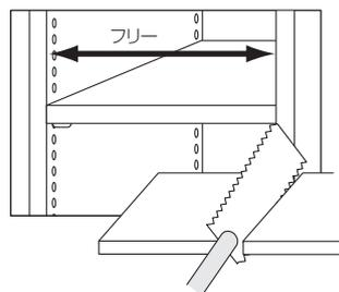
棚ダボをシステム穴に取り付けた後、可動棚を取り付けてください。
