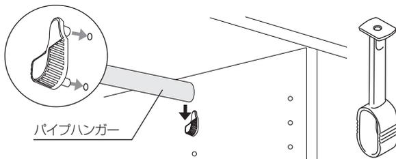
ブラケットをシステム穴に取り付けた後、パイプハンガーを取り付けてください。
