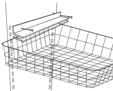
側板(仕切り板)にレールを同梱のビスで取り付けます。
