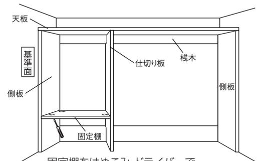
固定棚をはめこみ、ドライバーで締めつけ固定します。
