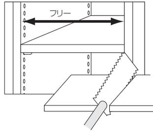
棚ダボをシステム穴に取り付けた後、玄関収納用棚板を取り付けてください。
