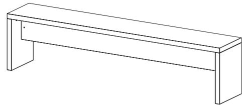
⚠ 座面と幕板の間に隙間がある場合は、幕板を押し上げながら締め直して下さい。
