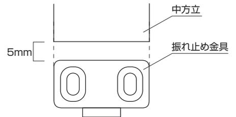
上吊り中方立取り付け用振れ止め金具(別売品)の場合
