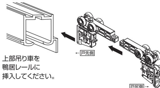
上部吊り車を鴨居レールに挿入してください。
