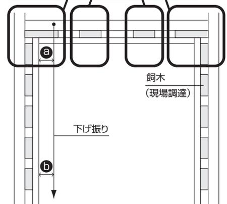
水準器などを使用し、 $a = b$  となるよう調整してください。併せて前後の建りも調整してください。
