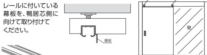
上部吊車を鴨居レールに挿入してください。
