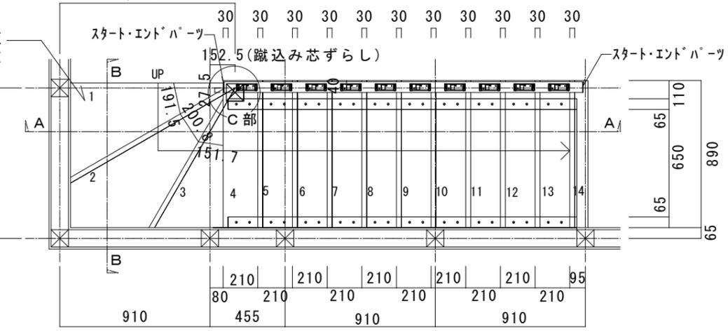
※ささら桁と廻り踏板軸芯柱は、干渉するため15mm欠き込みが必要です。
