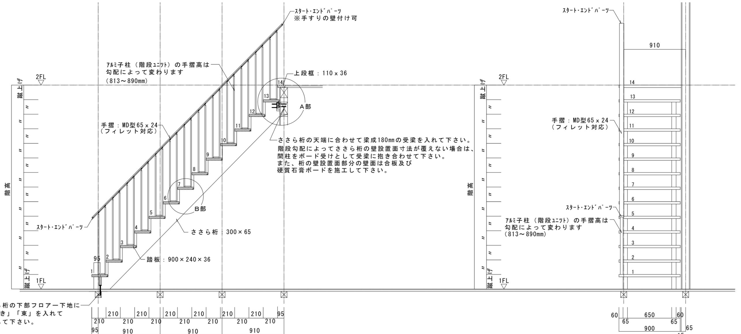
※ささら桁の下部フローア下地に「大引き」「束」を入れて補強して下さい。
