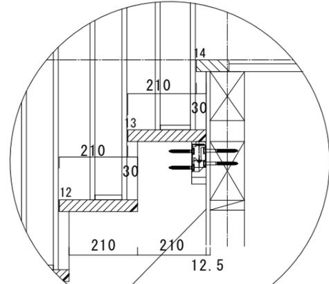
全てのアルミ子柱ユニットを段鼻と連結するため、上段框の鼻の出寸法を踏板の鼻の出寸法と同様にしています。
