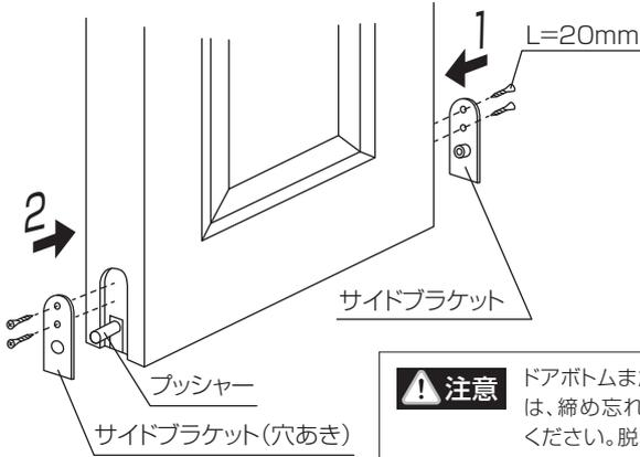
**注意** ドアボトムまたはサイドプレートを取り付けるビスは、締め忘れ、ゆるみ等のないよう確実にお締めください。脱落、損傷の原因となります。
