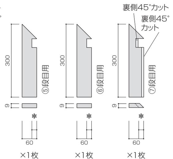
\*部分には直部分で指定した踏板鼻の出寸法から廻りの角度に合わせて加工されます。直部分とは異なる寸法で加工されます。
