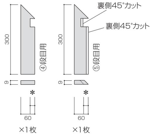
\*部分には直部分で指定した踏板鼻の出寸法から廻りの角度に合わせて加工されます。直部分とは異なる寸法で加工されます。
