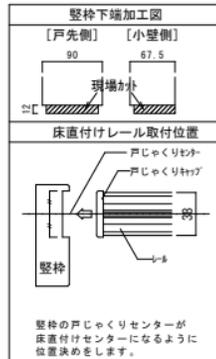
壁枠の戸ジャッキセンターが床直付けセンターになるように位置決めをします。
