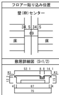
■縦断面図[床直付けレールタイプ]
